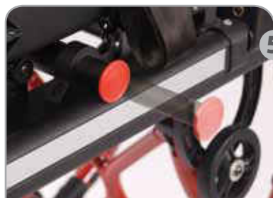
5 Asas Laterales de Levantamiento que permiten que operadores adicionales puedan ayudar en el levantamiento de pacientes pesados.
